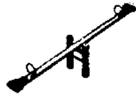
095. Huśtawka wężka. Wymiary (dł. x szer. x wys.): 3,0 x 0,4 x 0,6 m.
