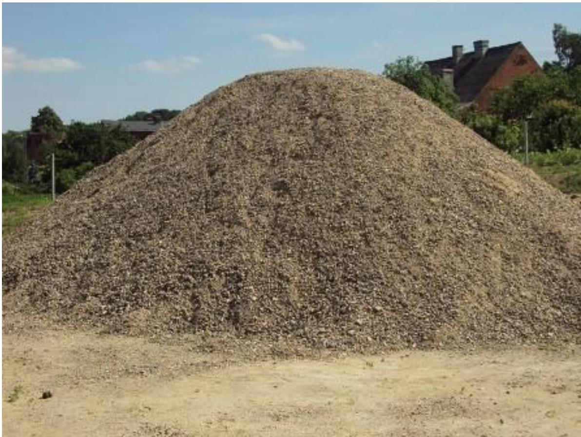
2. Podsypka 0-31,5 do wbudowania.
